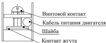
Рисунок 7 – Установка выхода на двигатель
